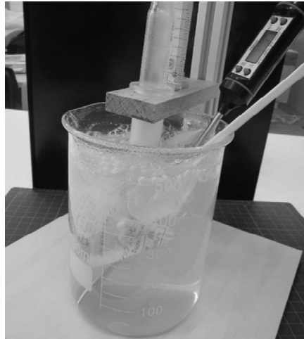
図 2-4 : 加熱剤による加熱
