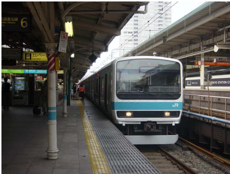
1998年から京浜東北線の世界に導入された。写真でも分かる通り、車体幅が広い。この車体幅の広さで不具合があった。たとえば、カーブでは車端部が車両限界(自動車や電車が守るべき車体断面)を超えてしまうので、車体の長さが20m級の車両で台車中心間距離(台車から1車両の中心までの距離)が標準的な13.8mになった。なお、京浜東北線では5編成のみの少数派である。近いうちに京葉線へ転属予定である。
