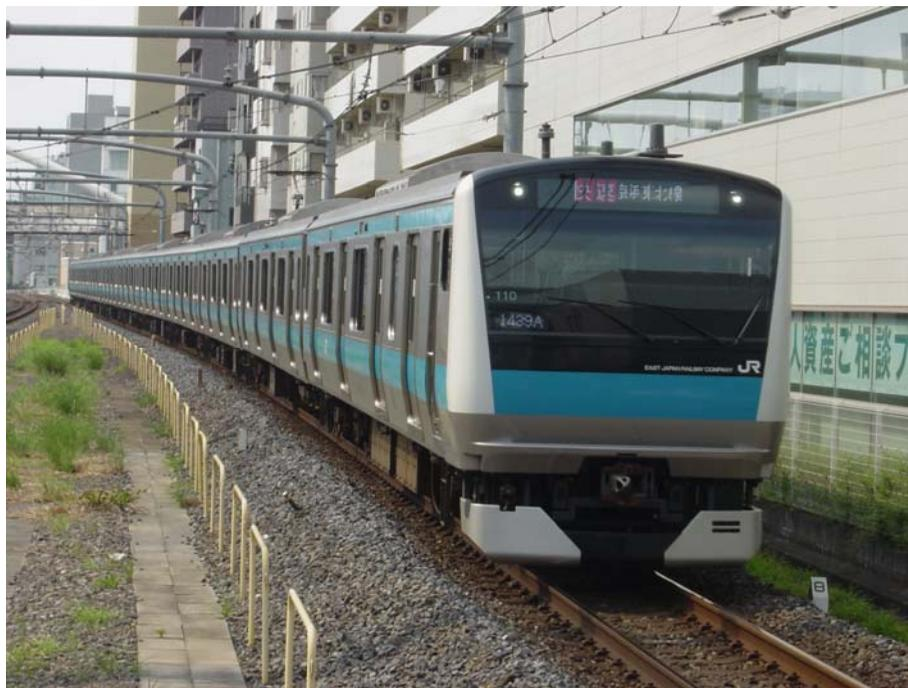
この車両は大幅にサービスを向上させた最新鋭電車である。2007年12月22日に初めて導入された。たとえば、クッション性の良い座席、車内案内表示器には17インチワイド液晶を採用している。優先席では荷物の棚と取っ手が低い位置に設置されている。運転席もスピードメーターが分かりやすい表示になった。腰掛の配色はラインカラーのイメージとリンクした青色ベースである。
