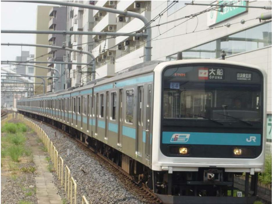
1991年に誕生した電車で2007年の12月から撤退が始まった。老朽化が原因である。209系は、「寿命半分、重量半分、価格半分」を製造基本概念として作られてきたので、従来の車両に比べて約半分の13年間で寿命だからだ。1995年から6ドア車が使用された。
