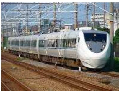
この車両は老朽化した485系を置き換えるために登場した車両で、最高速度は在来線最速の160km/hとなっている。しかしながら在来線では法律上130km/hまでしかたすことができず160km/hで運転されるのは、はくたかとして特殊方式で建設されたほくほく線を走るときのみである。
