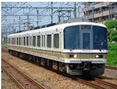
この車両はJ R 西日本の新快速などのスピードアップを図るために投入された車両で、今のアーバンネットワーク体制の基礎を気づいた車両ともいえます。最高速度は120km/hで、車内は転換クロスシートで構成されておりとても快適な設備となっています。今では奈良線や阪和線などの快速でも運用されています。
