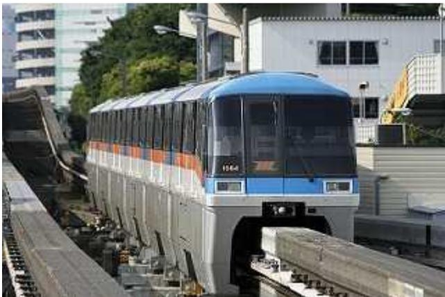
この車両は 1989 年に登場した車両で、現在の主力車両である。これ以前の車両は 3 両編成の車両を 2 編成連結した 6 両編成で運行されていたが、この車両からは 6 両貫通編成となった。登場時は赤とクリーム色だったがのちに現在の塗装に変更された。特徴としては抵抗制御であるが電気式ブレーキを採用して 6 両編成全車両電動車であるということである。
