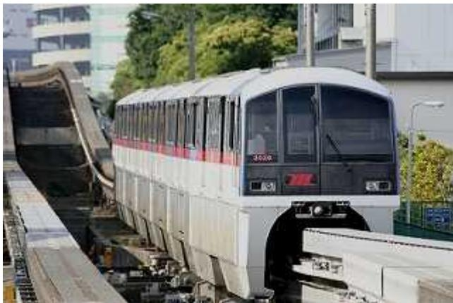
この車両は老朽化していた800系などを置き換えるために1997年に登場した車両。この車両は従来の車両と大きく異なり、IGBT素子のVVVFインバーター制御方式を採用してはじめての付随車を連結した。塗装は1000系とは異なり、赤帯と紫がかかった青色で構成されている。
