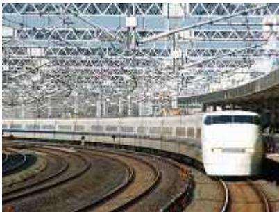
東海道新幹線における速度向上を目的に登場した車両です。東海道新幹線で初めて270キロ運転した車両であり、新幹線の車両の設計方針を従来の接客重視型からビジネス特化へ移行する指標となった車両です。しかし現在では引退する車両も出てくるなど世代交代も進んでいます
