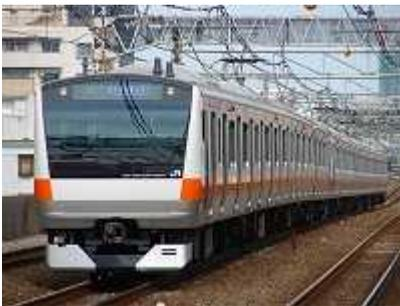
この車両は中央線の201系を淘汰するために、E231系を応用して登場した車両です。車両故障を防ぐために制御機器を2重系統化して故障に強い車両になっています。ほかにも京浜東北線への投入や、常磐緩行線への投入が決定しています。いずれはこの車両もE231系に次ぐJR東日本の顔となるかもしれません。
