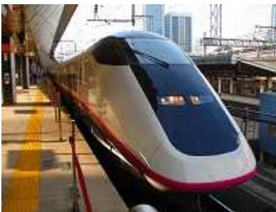
在来線に直通できるように車体の幅を狭くした新幹線で、「ミニ新幹線」と呼ばれています。そのため車内のシートは従来の3+2列から2+2列に変更されています。ただ、グリーン車は従来どおり2+2列のため少し狭く感じます。
