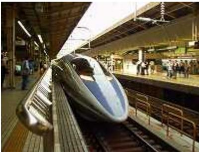
この車両は J R 初の 300km/h を達成した車両で、このとき再び世界最高速度の座に並びました。ただ、その最高速度を達成するため車両は丸くなり先頭も戦闘機のような形になりました。そのため車内は多少狭く感じ、サービスは低下したように思えます。ただ、グリーン車はヘッドレストを装備していて東海道・山陽新幹線の中で一番サービスが高いと思われます。
