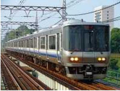
この車両はまず阪和線の関西空港乗り入れに伴い登場した車両で、車端部を除いて全て転換クロスシートとして空港利用客を考慮して荷物置き場を設置している。その後東海道本線にも投入され、こちらは荷物置き場が無くなり座席の数が阪和船線用より多い。この 223 系の投入により新快速電車が 130km/h で運転されるようになり、京都～大阪を 30 分で結ぶようになった。
