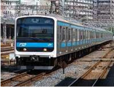
いわば JR 東日本の代名詞ともいえるくらい有名な通勤車両です。「製造コストの半減」「車両重量の半減」「車両寿命の半減」を掲げ多くの旧型車両を置き換えました。「走るんです」などと呼ばれ何かと悪者扱いされていますが、JR東日本で初のVVFインバーター本格採用車両となるなど残した功績は大きいものと感じられます
