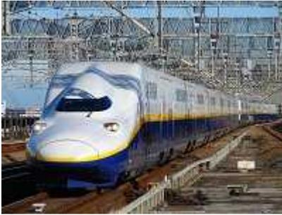
MAXは増え続ける通勤通学需要に対応するために投入されたオール二階建ての新幹線です。E4系は8両編成で最大16両編成で運転でき、1列車あたり最大1634名という高い輸送力を誇っていて、ラッシュ時は「通勤新幹線」として十二分に威力を發揮しています。
