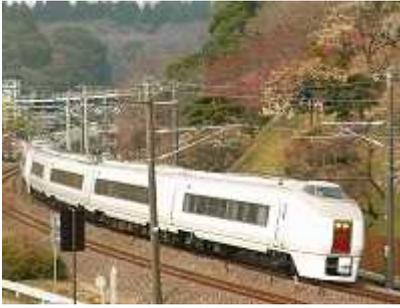
この車両はJR誕生後発の特急車両で、最高速度はJR初の130km/hです。車内はビジネスマンや観光客向けの設備となっていて、この特急のみ常磐線でグリーン車が連結されています。運用範囲は上野～仙台と常磐線全線に及んでいます。最近フレッシュひたちにも運用されています。
