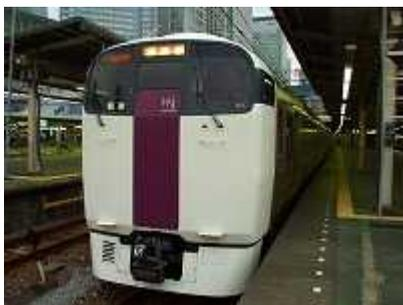
この車両はライナーや快速列車などに使用するために投入された車両で、全車両 2 階建てです。車内はボックスシートになっていて、網棚があるために少し狭く感じます。ただ、この車両は 2 扉だったため乗降に時間がかかり今ではホリデー快速とライナーのみで運用されています。
